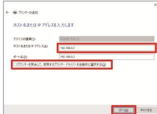
プリンターのIPアドレスを自動取得で設定した場合は、事前に本体のIPアドレスを確認しておく必要があります。本体のメニューから[通信設定の確認]>[IPアドレス]を選択することで確認できます。詳しくは、取扱説明書の「8-23. 通信設定の確認」を参照してください。
